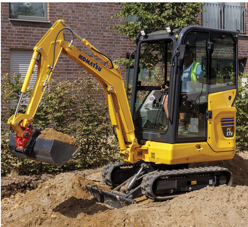
Obr.: Mini-rýpadlo Komatsu PC17R-5 při zemních pracích.
