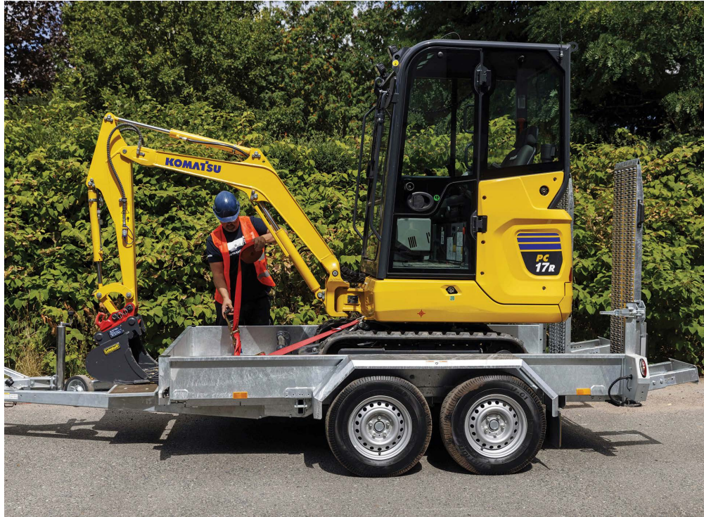
Obr.: Menší z mini-rýpadel – PC17R-5- lze snadno převážet také na klasickém vleku za osobním automobilem
